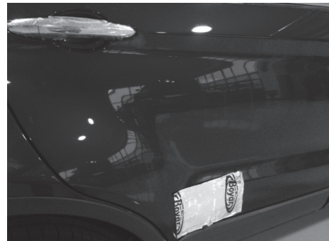
图5 后门外板灵敏度高的区域贴阻尼片
