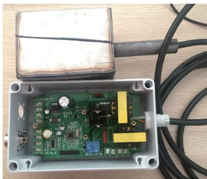
图9 超声波电源实物图
