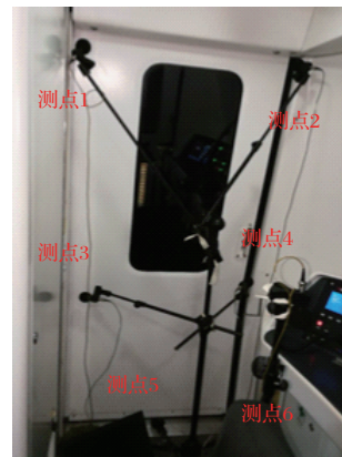
图4 司机室内藏门和座椅的测点布置
