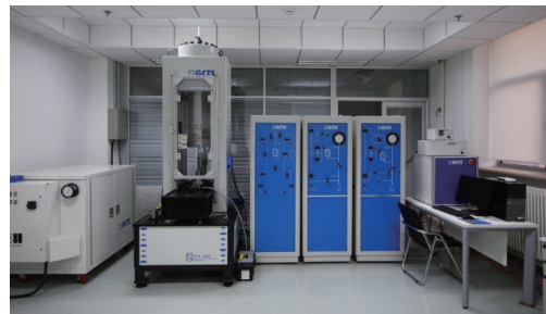
图3 GCTS RTR-2000 岩石力学三轴测试系统
