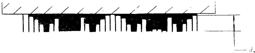
图 1 基于二次剩余序列 ( N = 17 ) 扩散吸声体的基本结构
