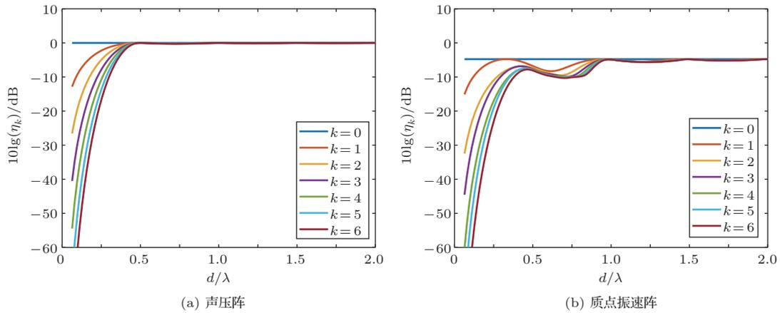
图11 随  $d/\lambda$  的变化的GS各阶波束的稳健性水平
