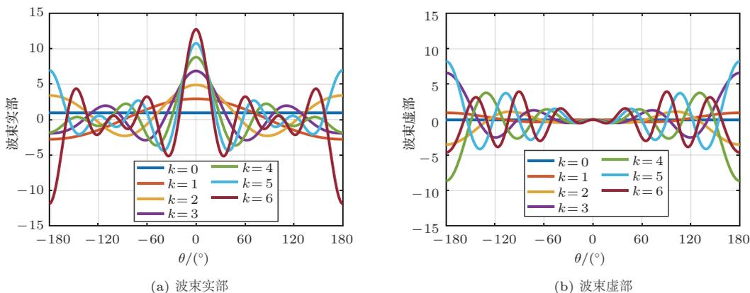
图4 声压直线阵 GS 波束实部和虚部 ( $x = 0.5$ , 即  $d/\lambda = 0.08$ )
