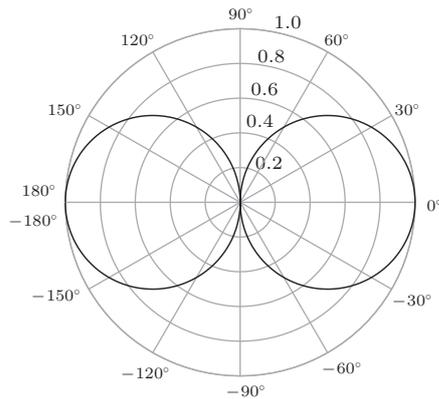
图2 质点振速传感器接收信号的空间响应
