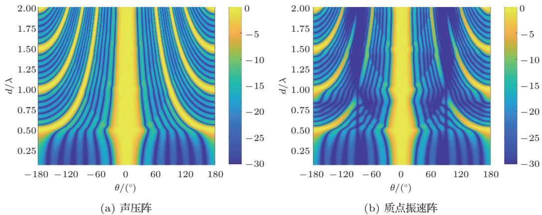
图7 随  $d/\lambda$  值变化的GS波束图
