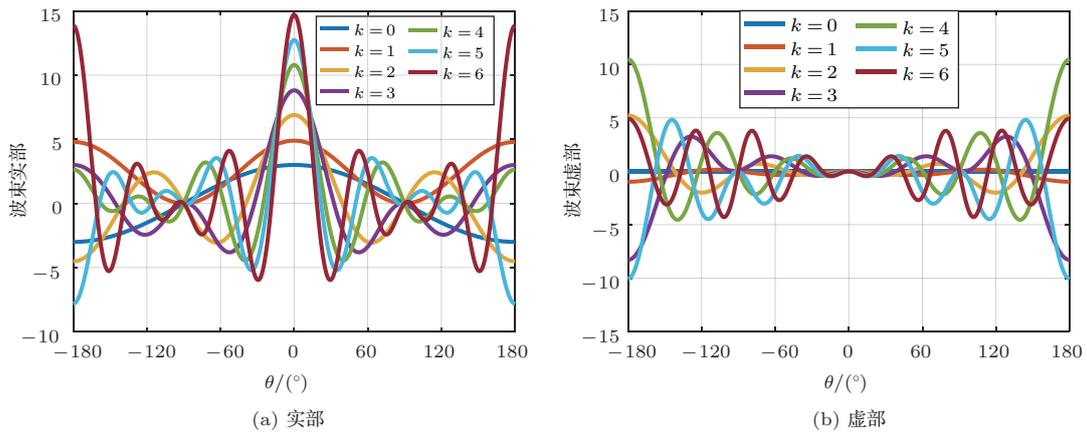
图5 质点振速直线阵GS波束实部和虚部 ( $x = 0.5$ , 即  $d/\lambda = 0.08$ )
