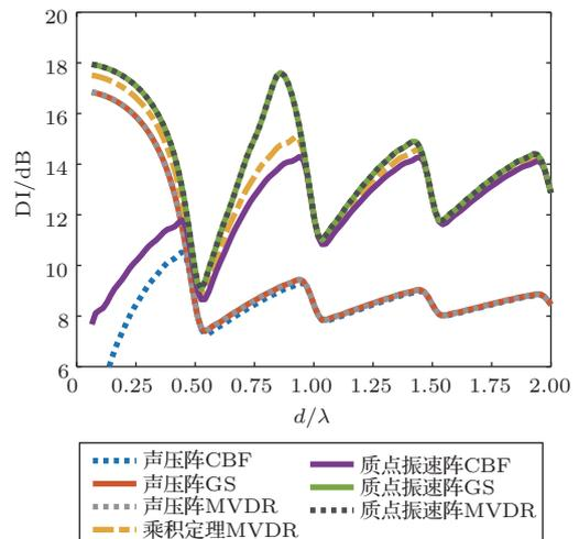
图9 随 $d/\lambda$ 变化的CBF、MVDR和GS方法的指向性指数
