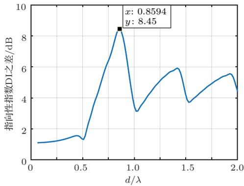
图10 随  $d/\lambda$  变化的质点振速阵超指向性方法的指向性指数与声压阵之差
