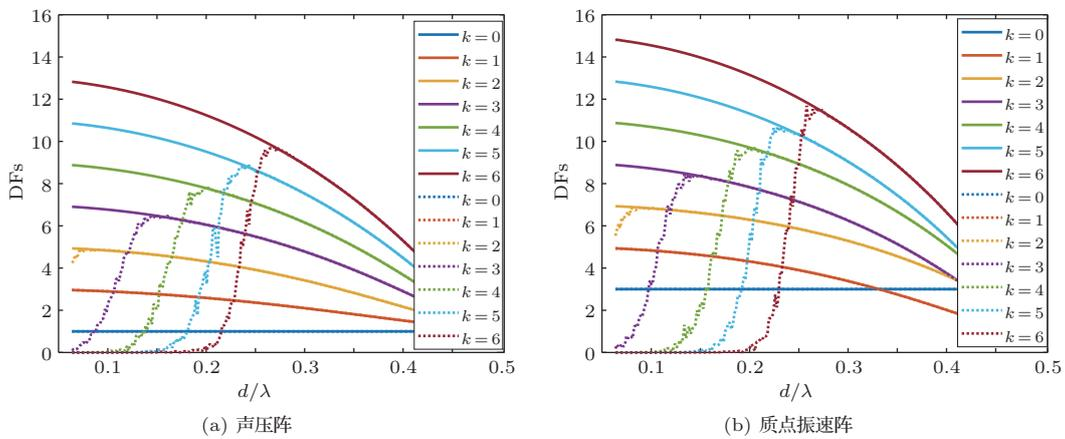
图12 随  $d/\lambda$  值变化的GS波束理论(实线)和有误差(虚线)时的指向性因子
