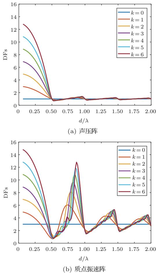
图8 随 $d/\lambda$ 值变化的GS波束各阶指向性因子
