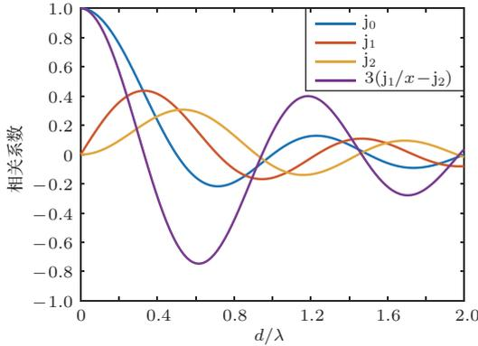
图3 随  $d/\lambda$  值变化的空间相关函数
