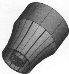
图 2 二分之一侧板开缝后的换能器
