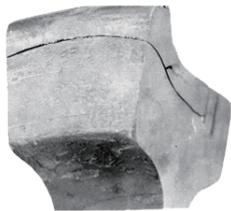
(a) 伤损车轮内部大面积辋裂缺陷
