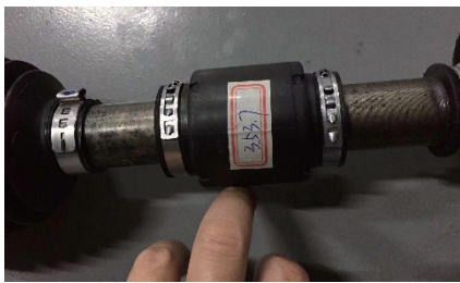
图 9 左传动轴增加吸振器
